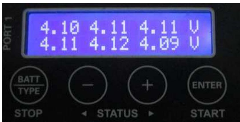
充電開始後、「+」のボタンを押すことにより、各セルの電圧を見ることができます。上記は6セルの充電なので、6個のセルの電圧が出てきております。最終的には、すべてのセルが4.20ボルトになるように充電されます。
