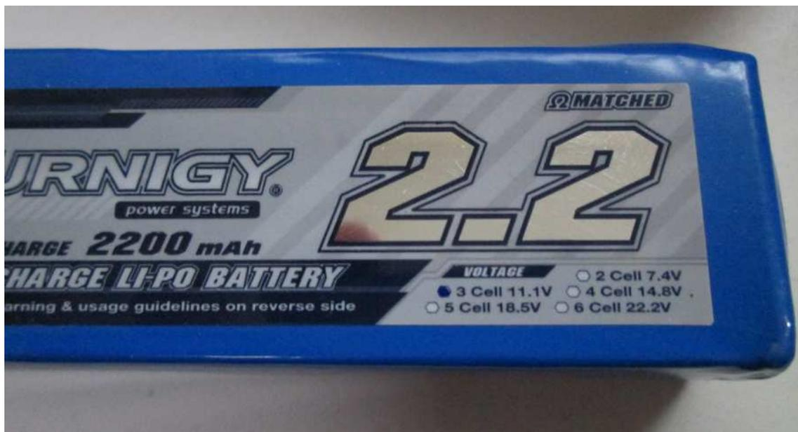
上記の電池は、リチウムポリマー電池の容量が2.2A、電圧が3セル直列の11.1ボルト仕様の電池です。
