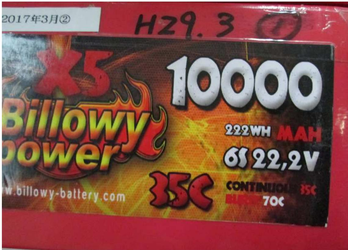
こちらの電池は、動力用に使われる容量10A電圧6セル22.2ボルトの物です。この場合は、10Aで6セル22.2ボルトの電圧で充電します。
