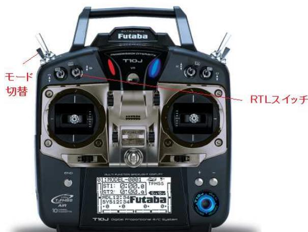
機体の操縦は、上記のようなプロポと呼ばれる2.4ギガヘルツ帯の送信機が使用されております。右および左のスティックで操作をします。
